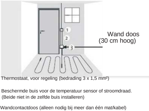
Fig. 2 Constructie samenstelling
