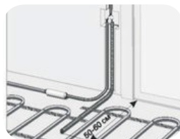
Voorbeeld van sensor in sleuven.
