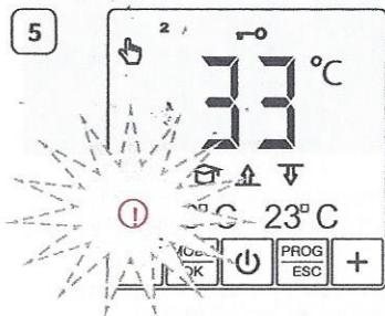
Die gewünschte Temperatur konnte über einen Zeitraum von 4 Stunden nicht erreicht werden - reduzieren Sie die Haltetemperatur.
