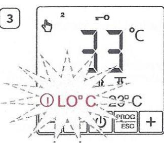
Anzeige im Fall eines BODENSENSORFEHLERS.
